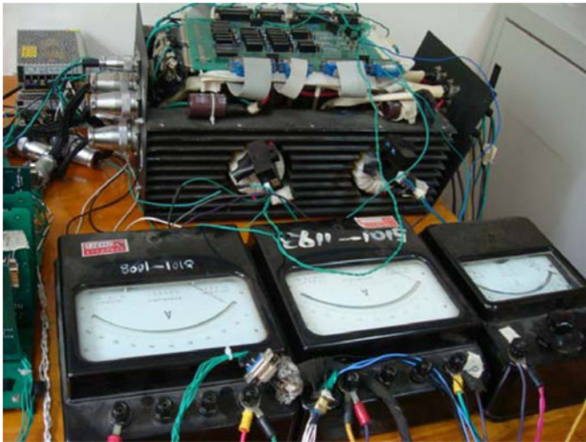
Fig. 7. Prototype of the PWM rectifier.
